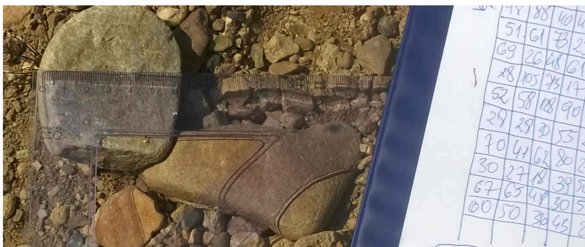
Fot. 5. Pomiar średnicy "b" ziaren żwiru i kamieni koryta rzecznoego potoku Żylica przymiarem milimetrowym (ISO 9195:1992(E))
